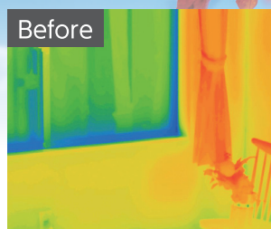
単板ガラス3mmのみ ＜サーモグラフィ画像＞※画像はイメージです
